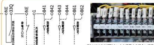
注)33Qは外付燃料タンクを設置する場合に接続が必要になります。
